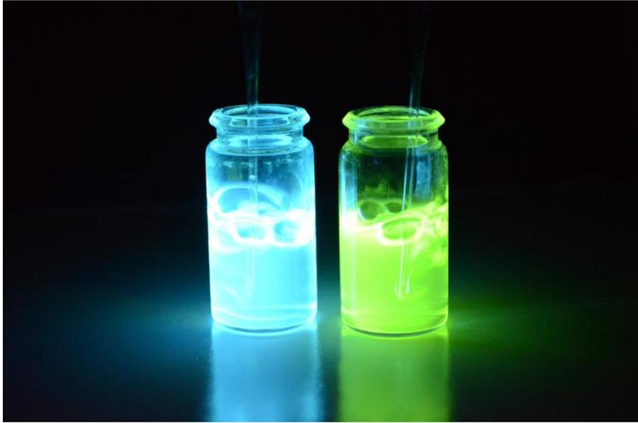
Die neuen Sensormaterialien ändern in Abhängigkeit vom Sauerstoffgehalt die Emissionsfarbe. Die abgebildete Sensorflüssigkeit zeigt eine Farbverschiebung von blau nach grün bei einer Abnahme des Sauerstoffanteils im durchströmenden Gasgemisch.
